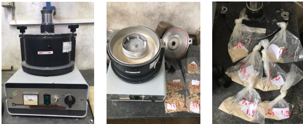
Figura 29. Moinho de material vegetal com crivo de 0,5 mm e amostras de tubérculos moídos.
