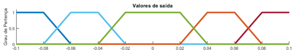
FIGURA 3.4: Funções de Pertinência Difusas para a obtenção do valor de saída
