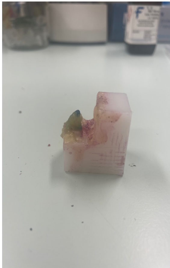
Figura 15 - Espécime fixado ao suporte de corte para micrótomo com cera cola.
