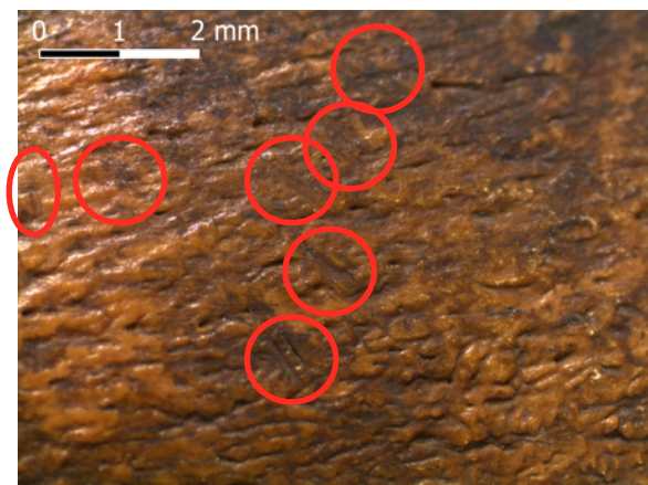
fig. 3.2.2. Stries non identifiées présentes sur toute la surface de la pièce ID33
