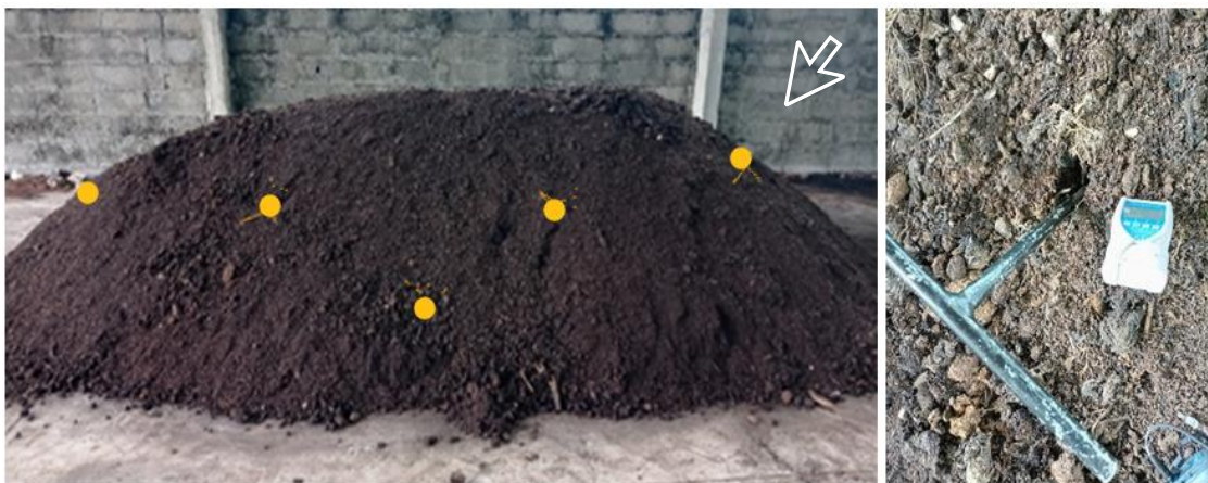
Figura 8. Pontos de leitura da temperatura e humidade na pilha (esq.); sonda para recolha de composto para análise do pH e condutividade elétrica, em laboratório, e sonda Schaller-humimeter FL2 para leitura da humidade e temperatura na pilha (dir.)
