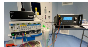
Figura 3: Eletrobisturi ligado a um equipamento de teste.
