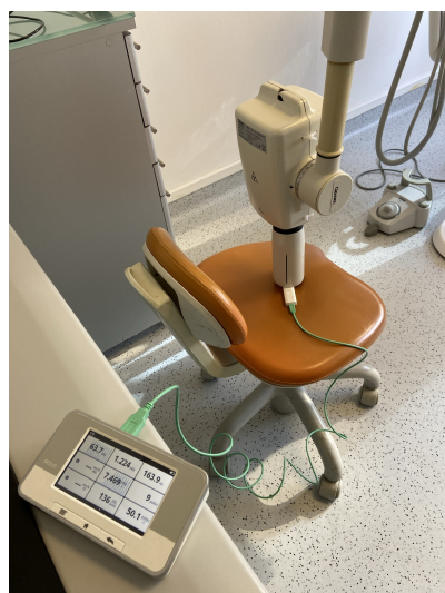
Figura 4.15: Teste de disparo com o equipamento de teste RaySafe X2 Solo DENT
