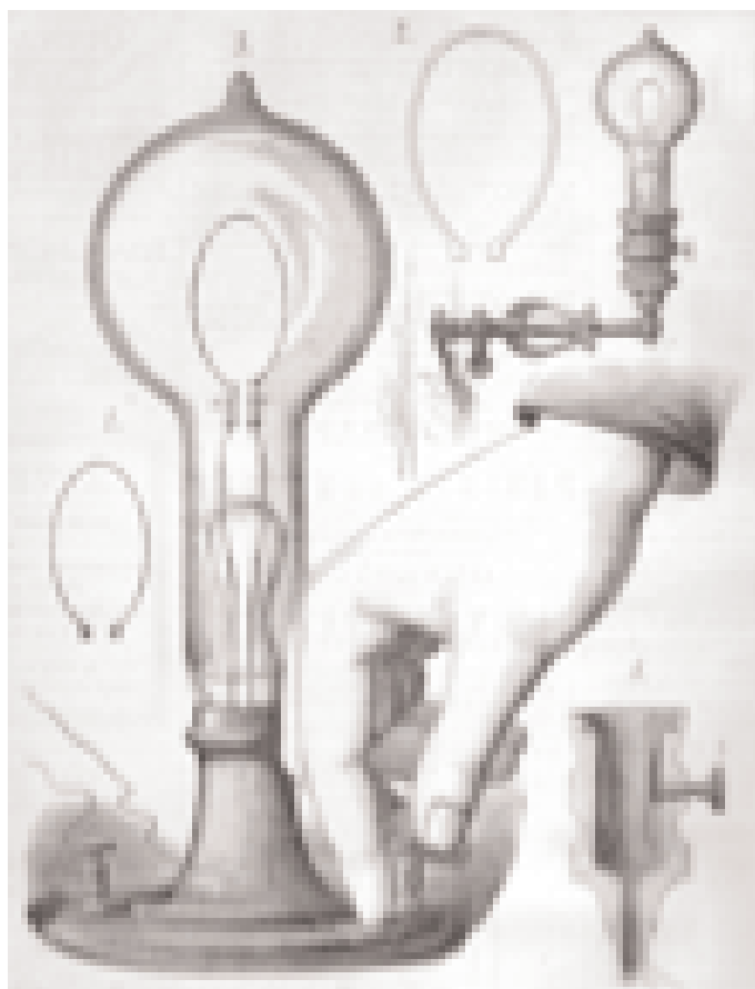
1. Carvão preparado. 2. Cartão antes da carbonização. 3. Forma da lâmpada. 4. Bocal da lâmpada.
