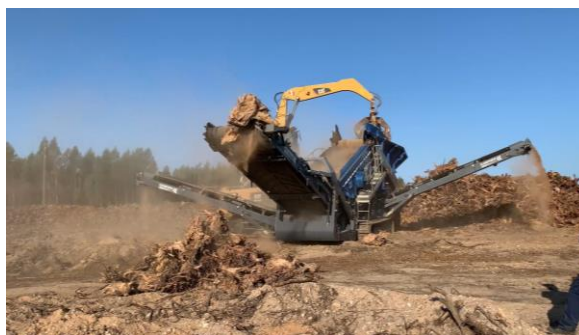
Figura 26 – Processo de crivagem de copos em ensaio de campo (elaboração própria).
