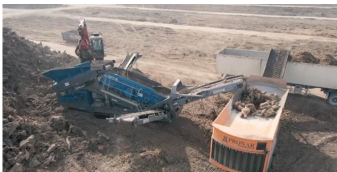
Figura 31 – Novo modelo operacional de trituração de ceptos com crivagem (elaboração própria).
