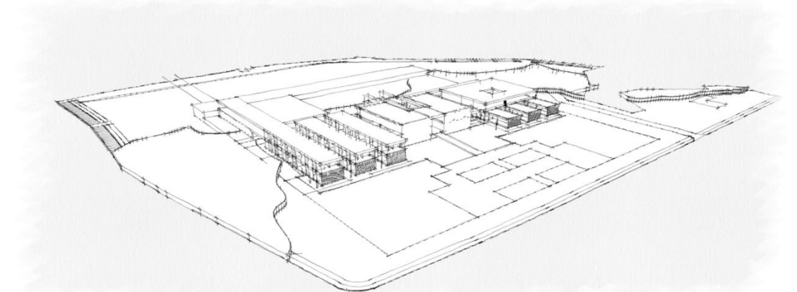
Figura 35. Fase intermédia – criação de taludes. Formato “pente” já presente.
