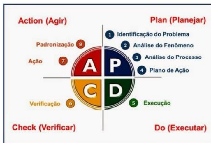
Figura 2 - Modelo PDCA para controle de processos de Manutenção
