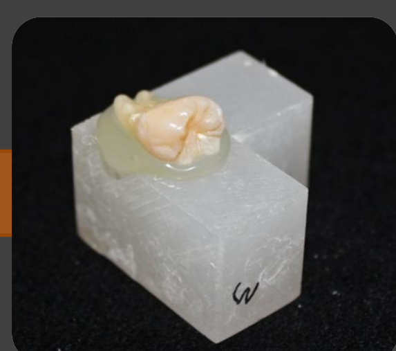
Fig. 3 e 4 - Montagem de um dente no dispositivo de fixação e corte com lâmina de diamante
