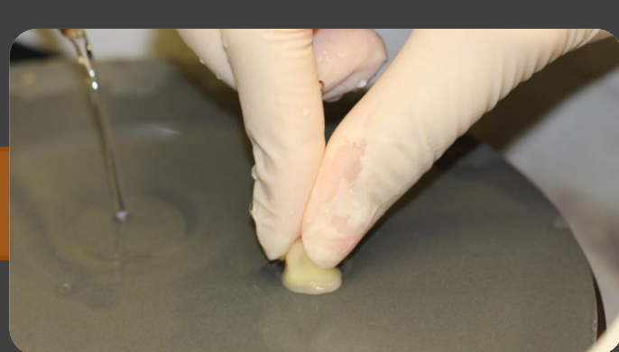
Fig. 5 - Dente a ser polido sob água corrente com lixa de SiC
