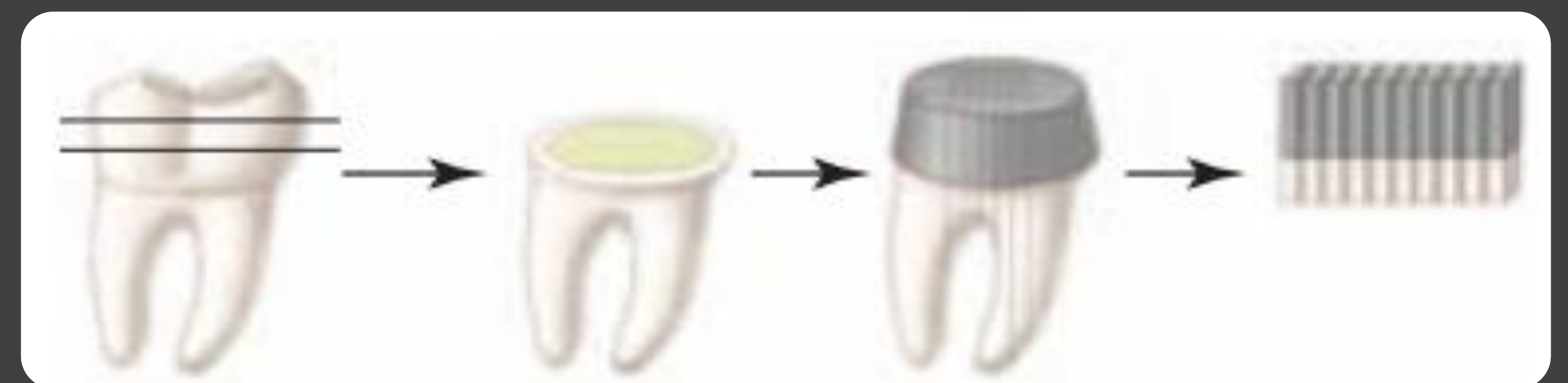
Fig. 2 - Preparação das amostras para o Teste de Microtracção (Fonte: Perdigão et al., 2002)
