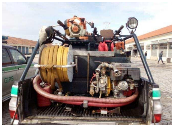
Figura 12 - VLCI equipado com o kit 1ª Geração Honda GX 200 [20].
