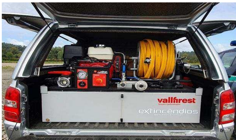
Figura 16 - VLCI equipado com o kit de 5ª Geração Honda GX 390 [24].
