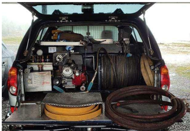
Figura 13 - VLCI equipado com o kit de 2ª Geração Honda GX 270 [21].
