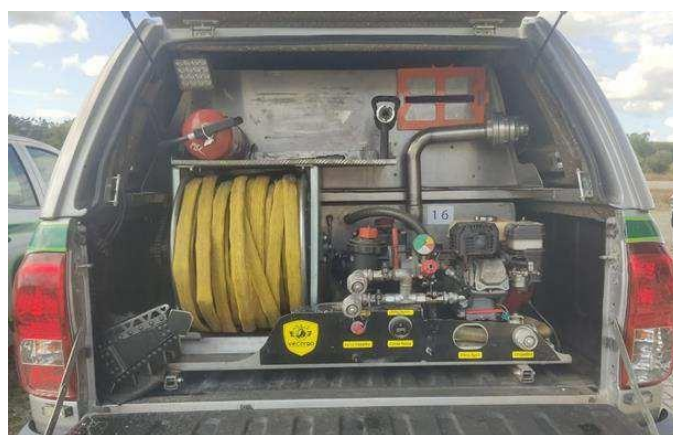
Figura 15 - VLCI equipado com o kit de 4ª Geração Honda GX 200 [23].
