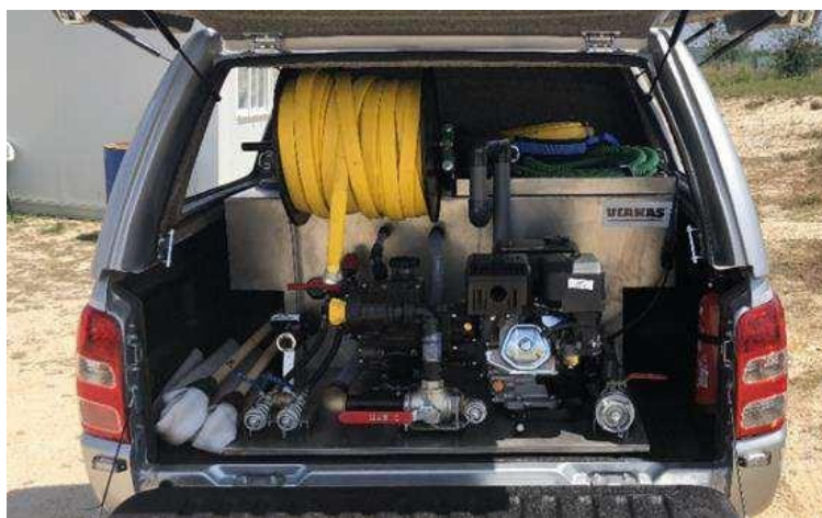
Figura 14 - VLCI equipado com o kit de 3ª Geração Rato R 420 [22].
