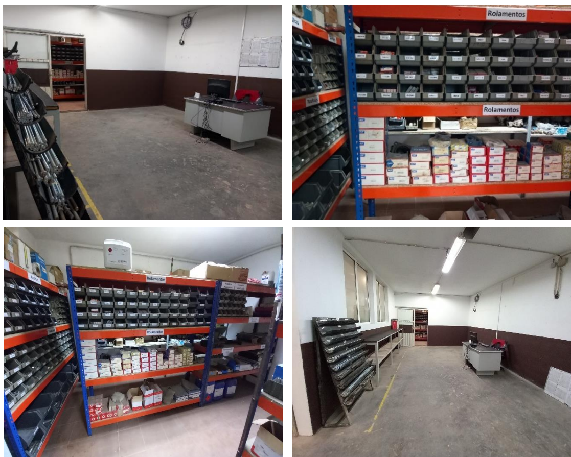
Figura 20 - Depois da Implementação de 5S na serralharia
