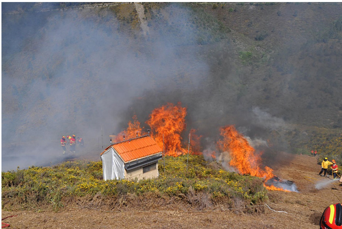
Figura 1. Vista de um ensaio de propagação do fogo em vegetação arbustiva, para avaliar sistemas de proteção de componentes de uma construção em madeira.
