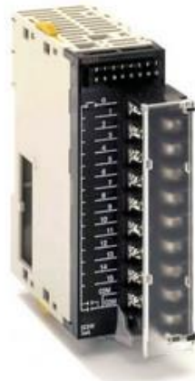
Figura 24 - Módulo de entradas digitais, CJ1W-ID211 (OMRON, 2021).
