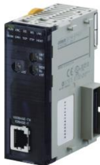
Figura 22 - Módulo Ethernet , CJ1W-ETN21 (OMRON, 2021).
