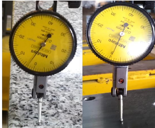
Figura 4.2 Valor máximo encontrado na variação entre ponto 1 (imagem esquerda) e ponto 2 (lado direito).
