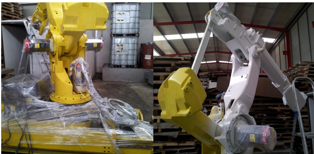
Figura 4.12 Pintura do robô, processo de preparação para a pintura
