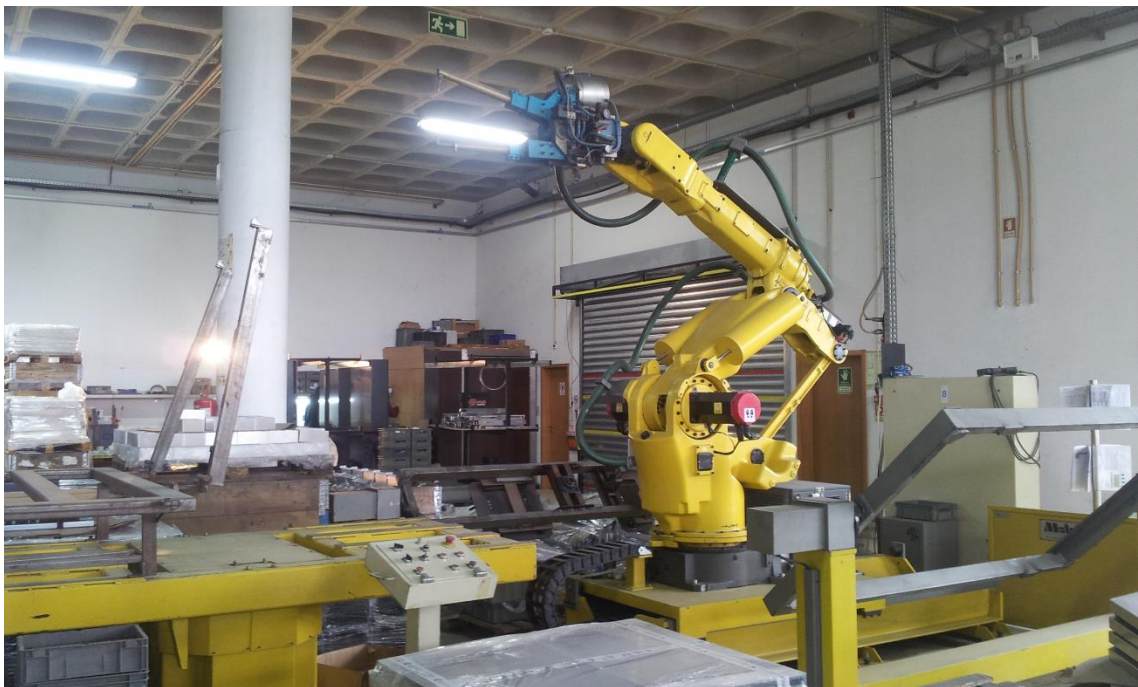
Figura 4.1. Robô de soldadura por pontos Fanuc 420 iF.
