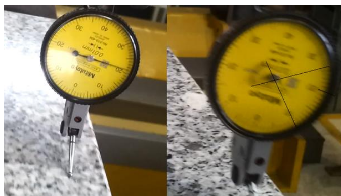
Figura 4.3. Variações máximas encontradas ao longo da execução de uma trajetória. O máximo da variação ao longo do deslocamento em linha reta foi de 0.21 mm (imagem da esquerda). Perante uma mudança brusca de direção, ocorreu uma variação brusca entre 0.1 e 0.25 mm.
