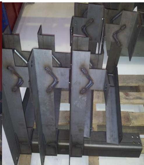
Figura 2.9. suportes da estrutura do cone de admissão pronto para pintura
