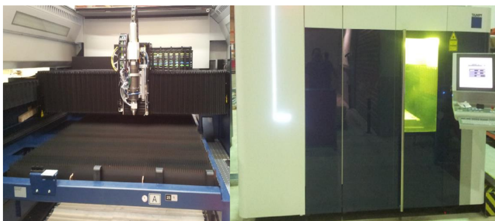
Figura 1.3. Trumpf Trulaser 5030, máquina de corte 2D, lado direito interior da máquina, lado esquerdo exterior da máquina
