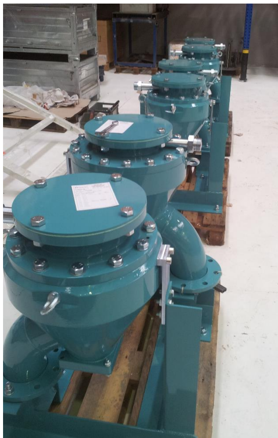
Figura 2.10. Conjunto de cones de admissão após montagem final e pronto para embalagem
