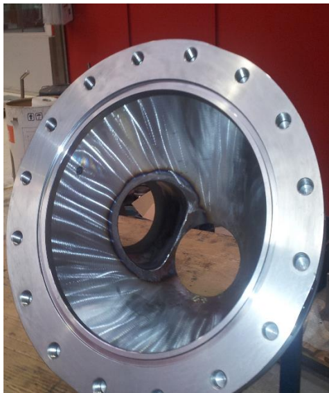
Figura 2.8. Cone de admissão após soldadura de aro de fixação da tampa
