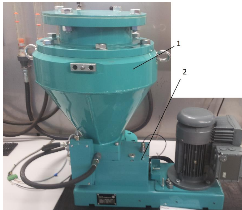
Figura 2.1. K50+Gearbox, 1-Cone de admissão, 2-Gear box
