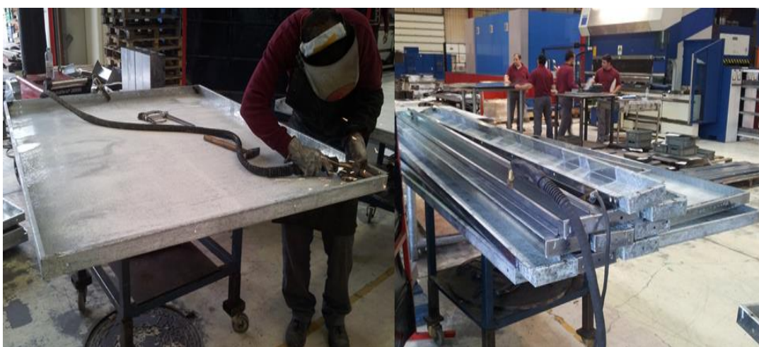
Figura 4.11 Processo de soldadura das laterais após estas terem passado pela quinagem.
