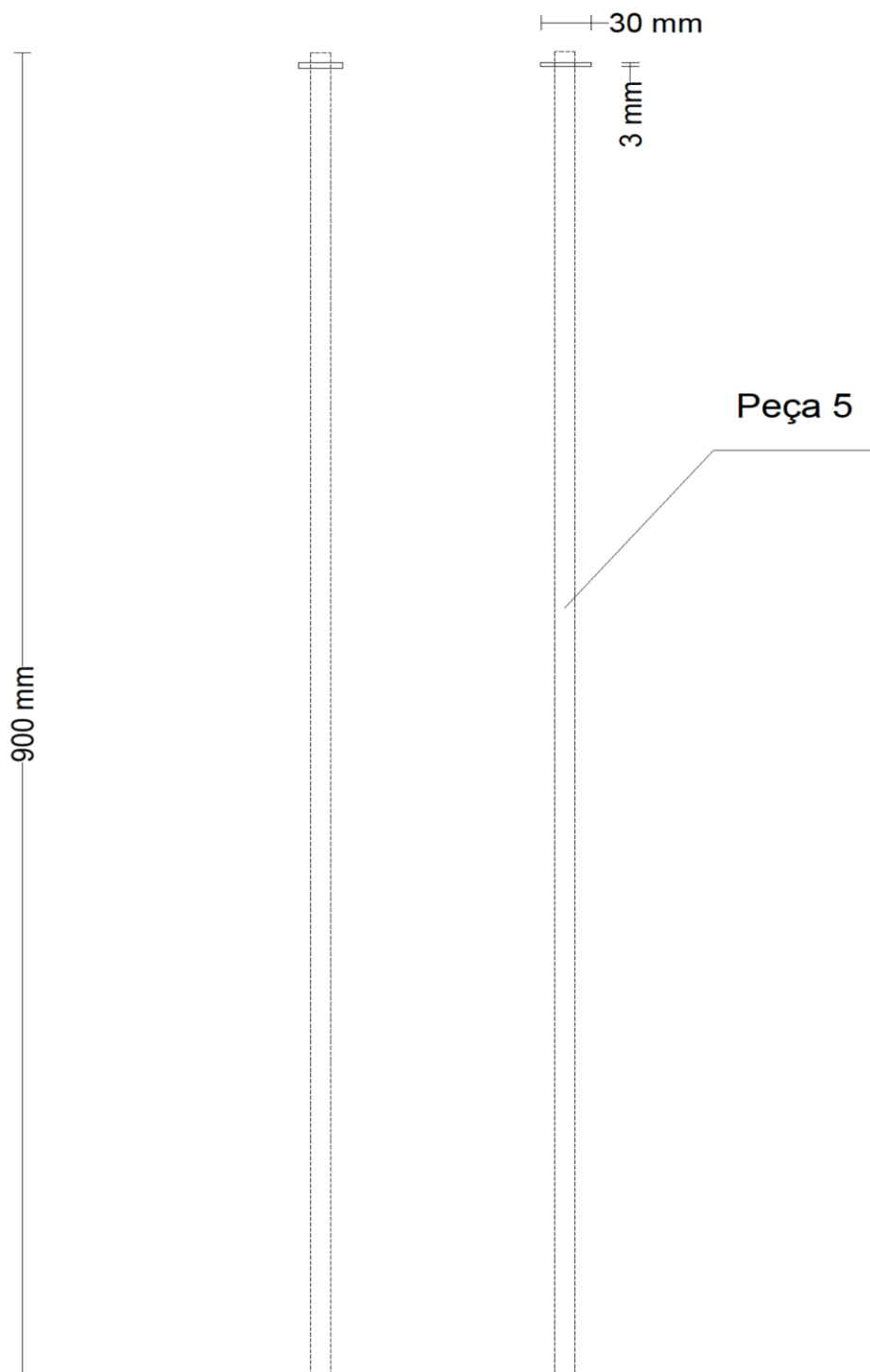
Figura 10 - Varão de 12 mm roscado, conforma a norma DIN 976-1A (Fonte: produção própria)
