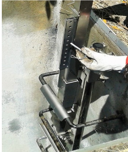
Foto 23 – Colocação da cavilha entre guias para bloqueamento do pré ajuste (Fonte: produção própria)
