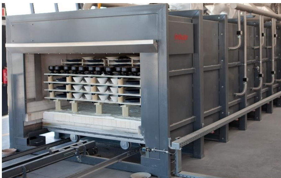
Figura 47 – Forno Túnel 60m 1300°C (Fonte: Matcerâmica)
