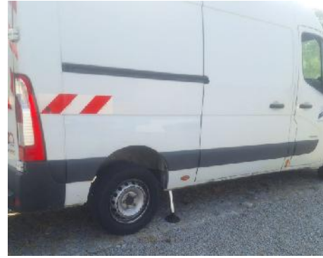
Figura 51 - Estabilização de uma PEMP
