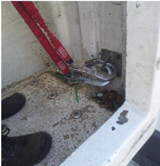
Figura 52 - Ponto de ancoragem da PEMP
