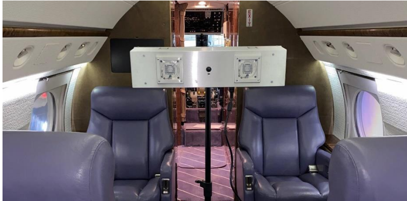
Figura 13 - Exemplo De Lâmpada UV Proposta A Sip.
