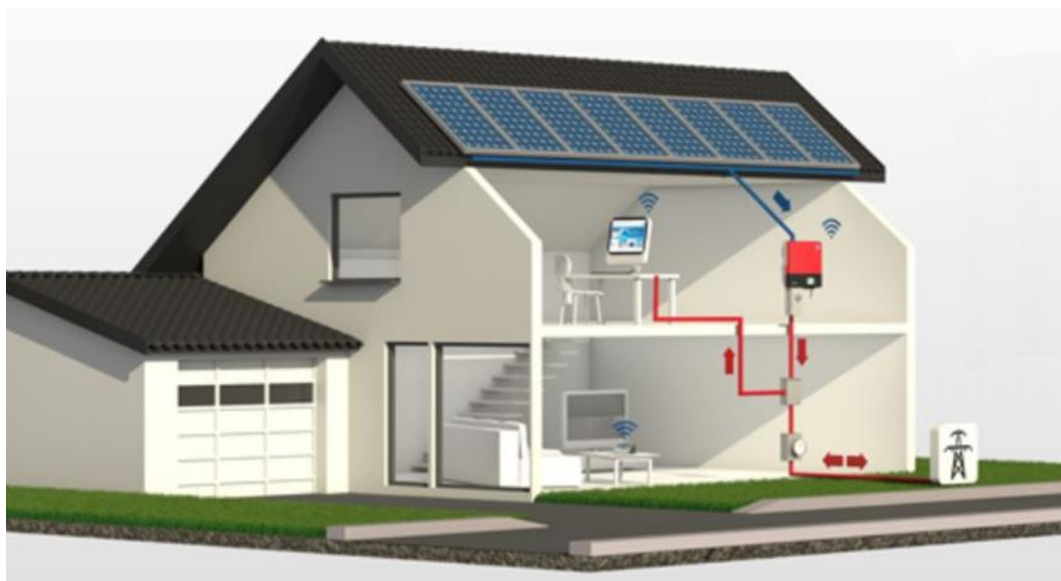
Figura 24 – Configuração de um sistema Grid-Tie [20]
