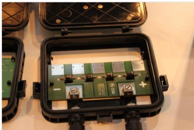
Figura 17 - Caixa de junção de um módulo fotovoltaico [11]
