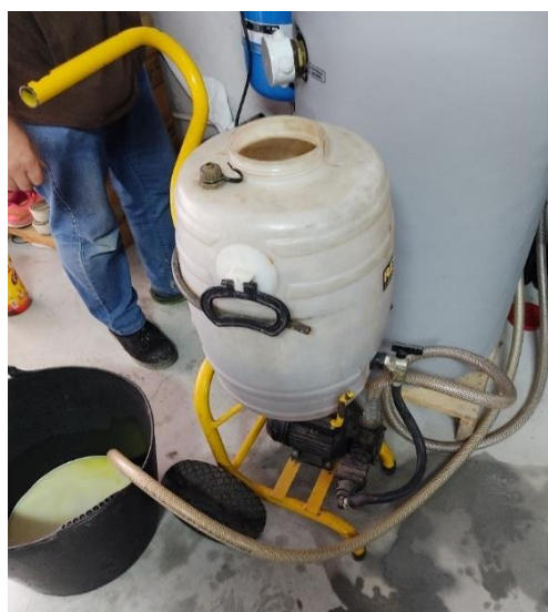
Figura 75 - Unidade de enchimento e descarga elétrica
