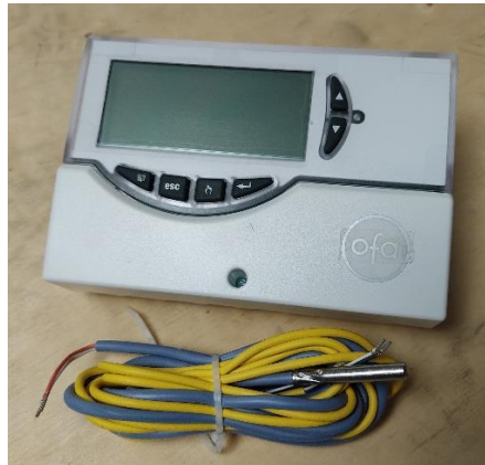
Figura 13 - Controlador solar e sondas de temperatura
