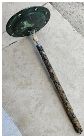
Figura 78 - Ânodo de magnésio do termoacumulador
