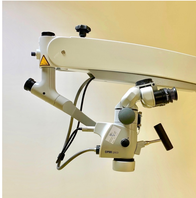
Figura 17. Microscópio utilizado para controlo de polimento (Carl Zeiss Meditec AG, Jena, Germany).
