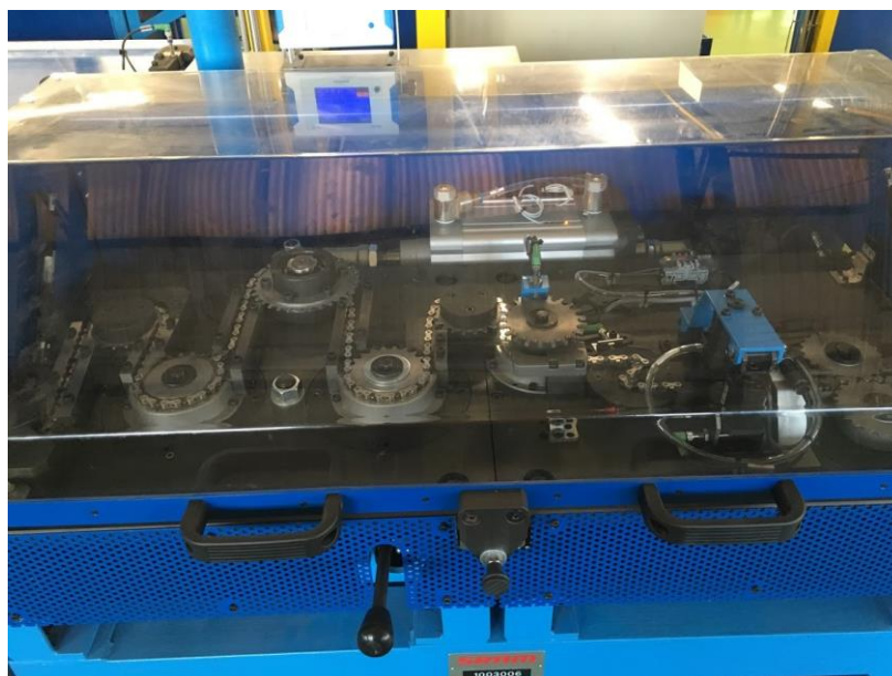
Figura 3-6 - CTG - Máquina de tensionamento e controlo da corrente
