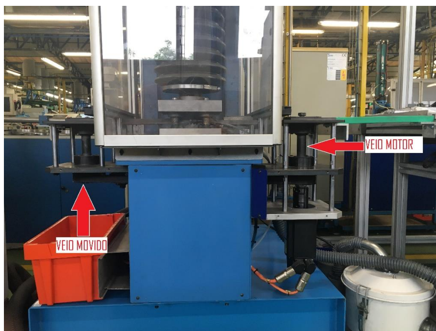
Figura 5-2 - Constituição da prensa de rebtagem (RDP) da linha 6
