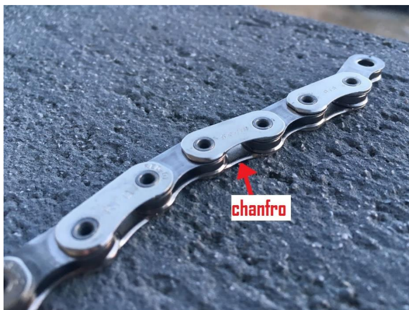
Figura 5-28 - Corrente SRAM RED com detalhe relevante para o descarte, na régua 1, de uma posição da placa
