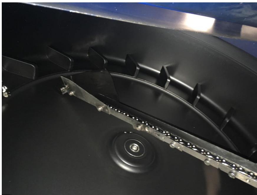
Figura 5-27 - Régua de transporte de placas desde das cubas até ao módulo
