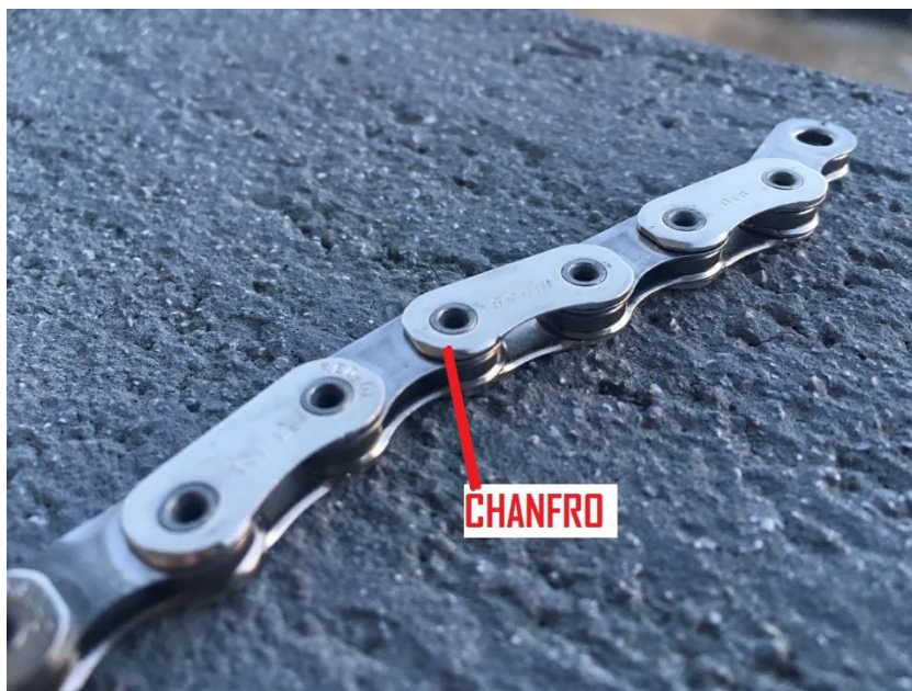
Figura 5-29 - Corrente SRAM RED com detalhe relevante para o descarte, na régua 1, de uma posição da placa
