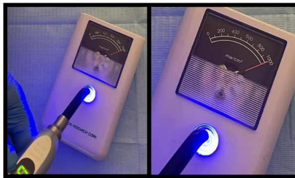
Figura 5 - Verificação da potência do fotopolimerizador através de um radiômetro
