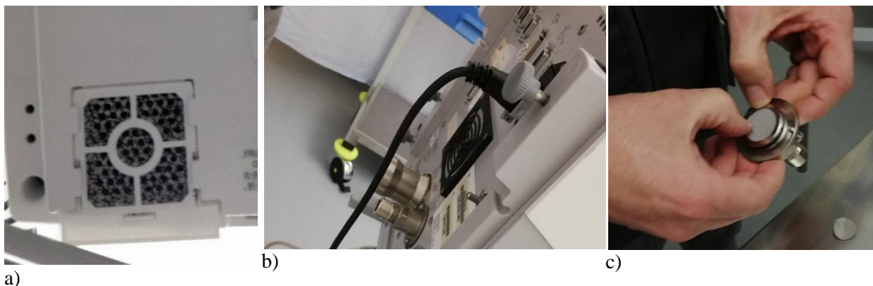
Figura 63 - a) Filtro do monitor, b) Filtro do ventilador e c) Filtros de entrada de ar
