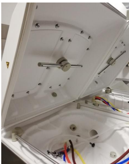
Figura 83 - Substituição do sistema rotativo
