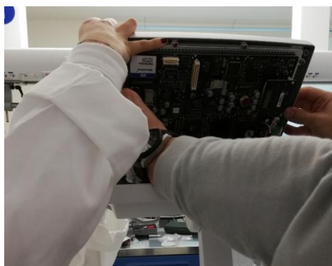
Figura 64 – Substituição da pilha do CPU
