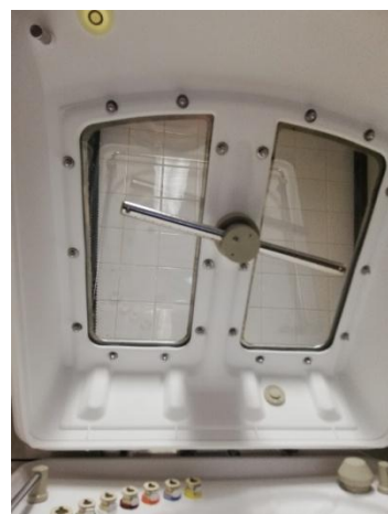
Figura 84 - Substituição do sistema rotativo, na imagem a) surge a porta sem o sistema rotativo e na imagem b) já se encontra o sistema rotativo colocado
