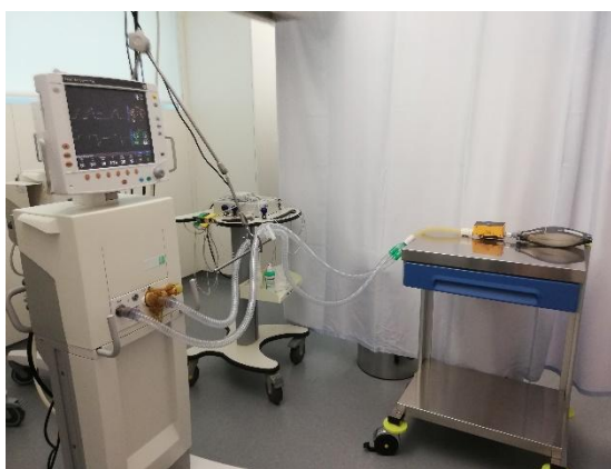
Figura 67 - Verificação do funcionamento do ventilador com o equipamento de teste
