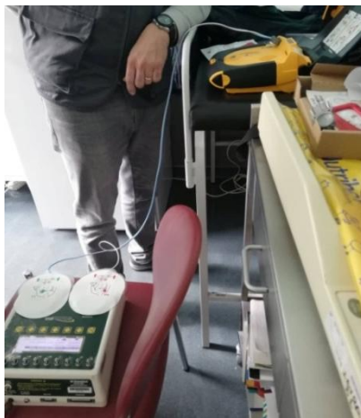
Figura 10 – Realização da manutenção preventiva do DAE, simulação de uma paragem cardiorrespiratória através do equipamento de testes de desfibrilhação
