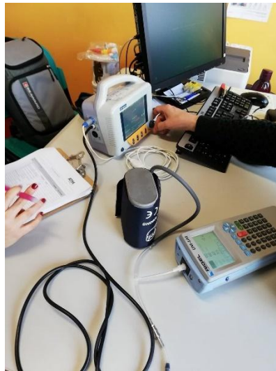
Figura 69 - Realização do ensaio da pressão não invasiva com o equipamento de teste multiparamétrico
