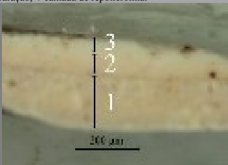
Fig. 140 Amostra estratigráfica CP_4_40x.
