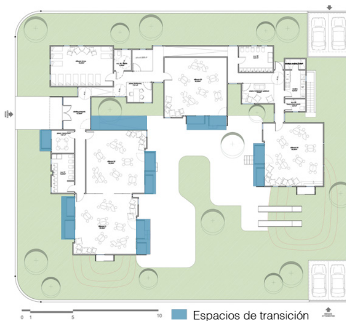
Fig. 27 Esquema de los espacios de transición generados por las pérgolas en planta
