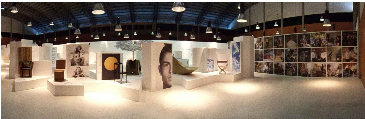
fotografias que demonstram as excessivas zonas de sombra e incandescência da iluminação da pré-existência
