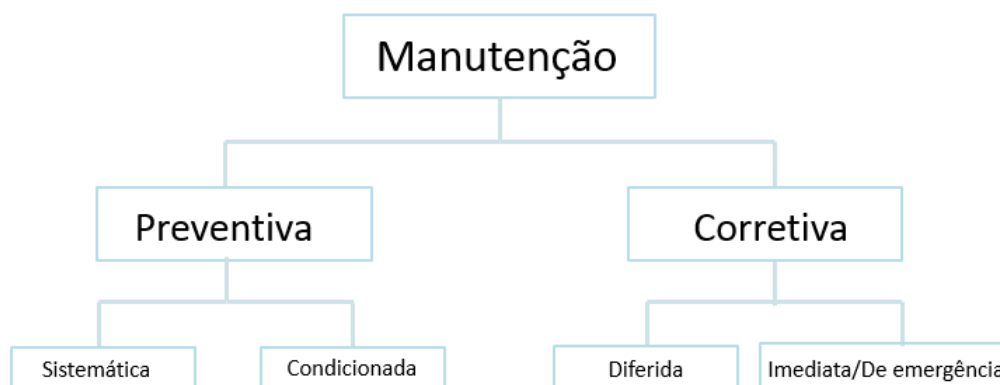
Figura 2.1: Visão geral sobre os tipos de manutenção
