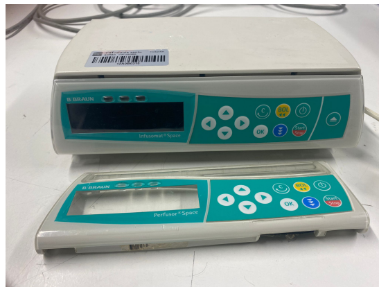
Figura 3.47: Manutenção corretiva: Bomba infusora
