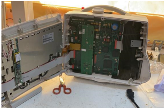
Figura 3.16: Manutenção corretiva de um monitor de sinais vitais
