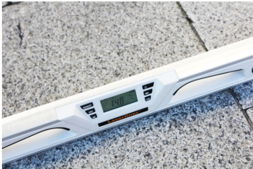
Fig. 4.16. Imagen de una de las mediciones efectuadas mediante inclinómetro digital en la Rúa Poboadores de Vigo con un 14% de pendiente.
