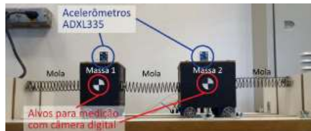
FIGURA 1.9: Utilização de acelerómetros no estudo de vibrações.
