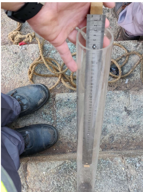
FIGURA 2.13: Instrumento de auxílio para medições de calados
