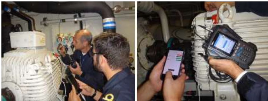
FIGURA 1.11: Teste de medidor de vibrações de baixo custo. Fonte:(Ramos, 2019)
