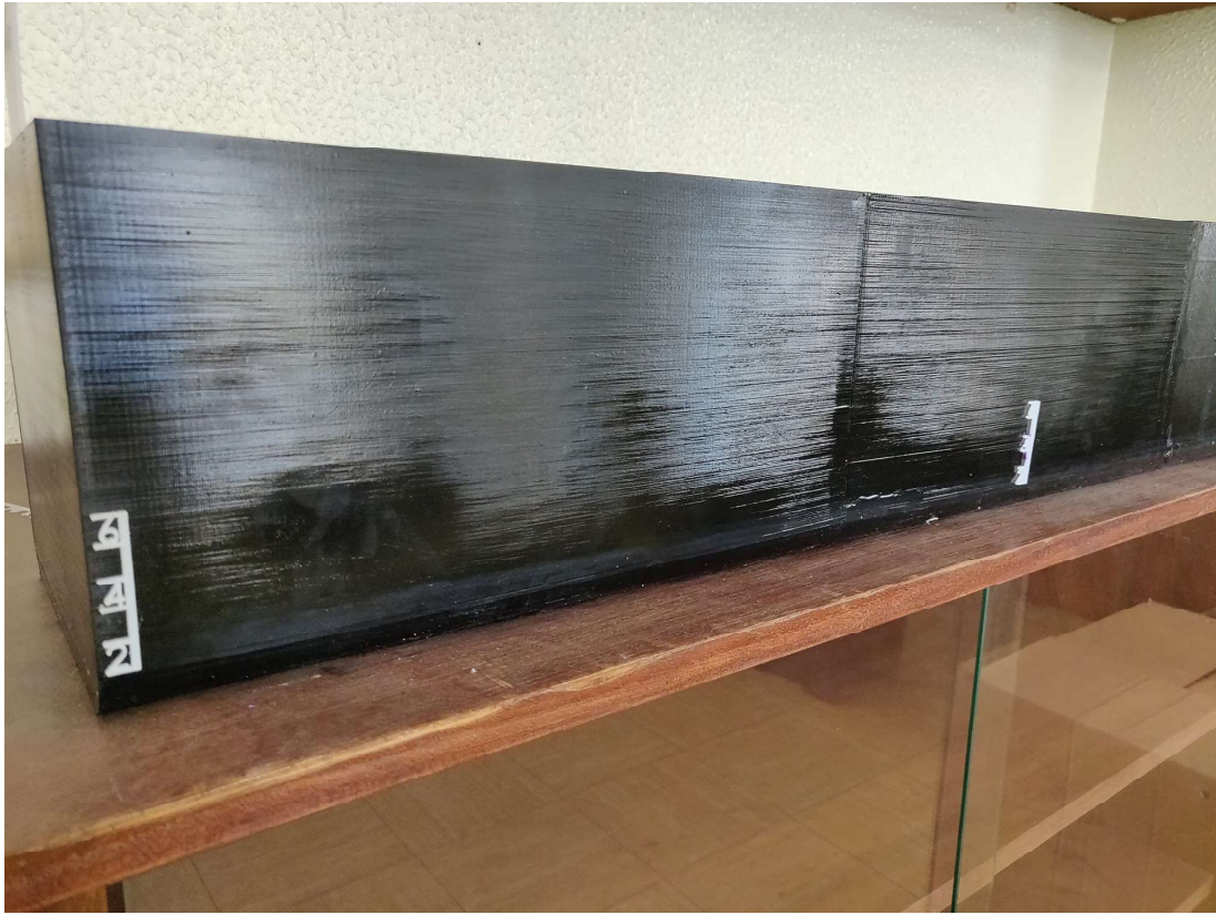
FIGURA 4.13: Marcas de calado
