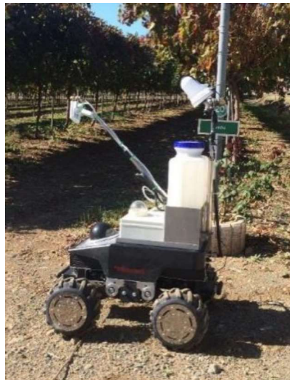
Figura 1-6 Sistema robótico com rodas quando se desloca numa vinha [22]
