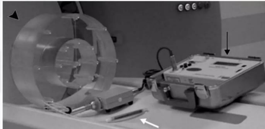
Figura 15: Representação da obtenção do valor de CTDI_{100} . Colocação de uma camara de ionização em forma de lápis no centro do fantoma (C. H. McCollough et al., 2011)
