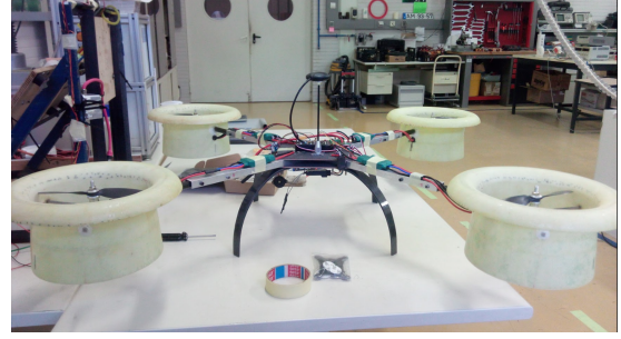
(b) Estrutura física final do RPAS
