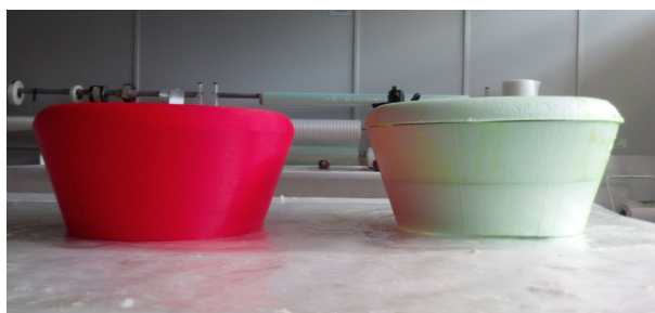
Figura 4.4: Condutas resultantes da impressão 3D e do corte através de fio quente
