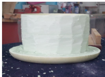
(b) Parte da espuma removida com auxílio de x-acto
