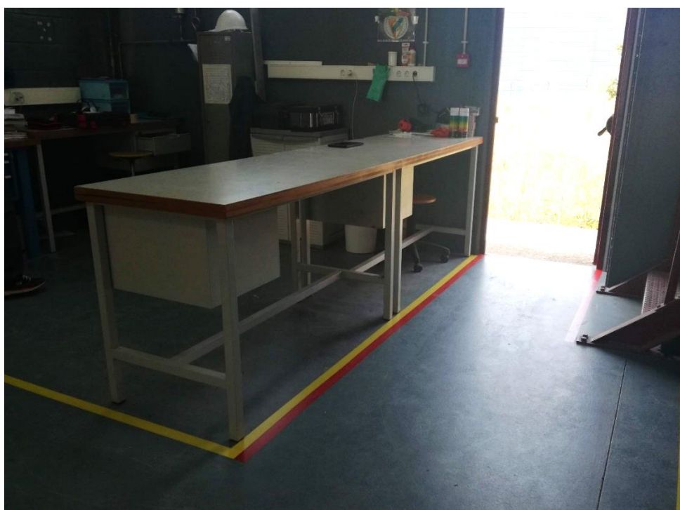
Figura 3.45 - Indicação da saída de emergência com fita vermelha
