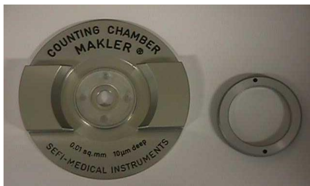
Figura 11 - Câmara de contagem Makler utilizada para avaliação do número e da mobilidade dos espermatozoides.
