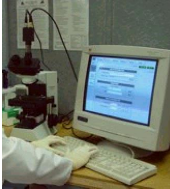
Figura 12 - Sistema computadorizado de análise de esperma. Hamilton Thorn Motility Analyser (HTM-C), constituído por um microscópio adaptado com objetivas de contraste de fase negativa, uma câmara de vídeo, um monitor e um computador com programa para análise de esperma.
