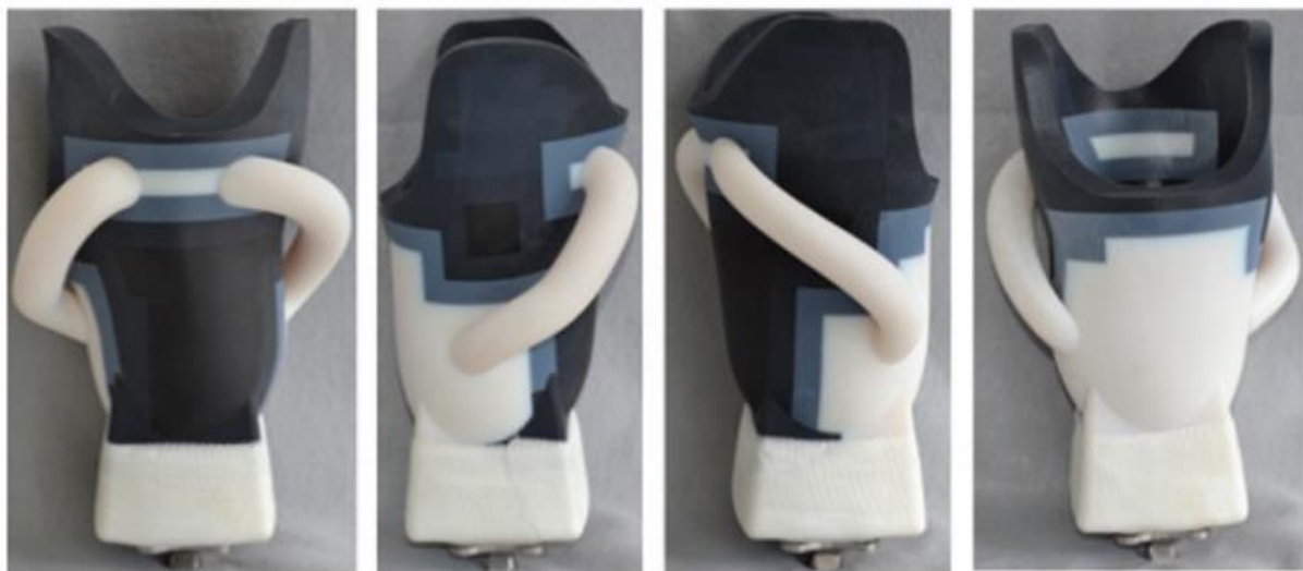
Figura 2-13 - Socket impresso em impressora 3D (Fonte: Sengeh, 2013)
