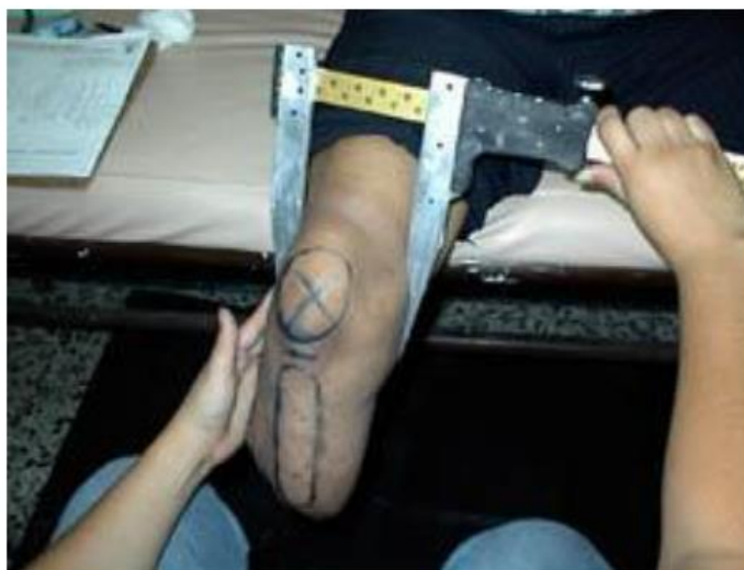
Figura 2-3 - Recolha de medidas com o paquímetro (Fonte: Queiroz, 2008)
