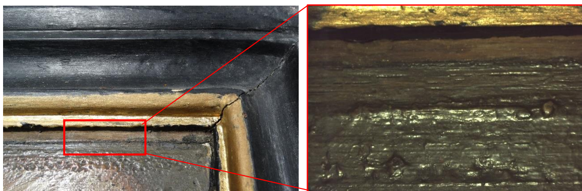
Figura 7 – Localização da rebarba na frente da pintura e respetivo pormenor, MO, ampliação x6,4, A.P.
