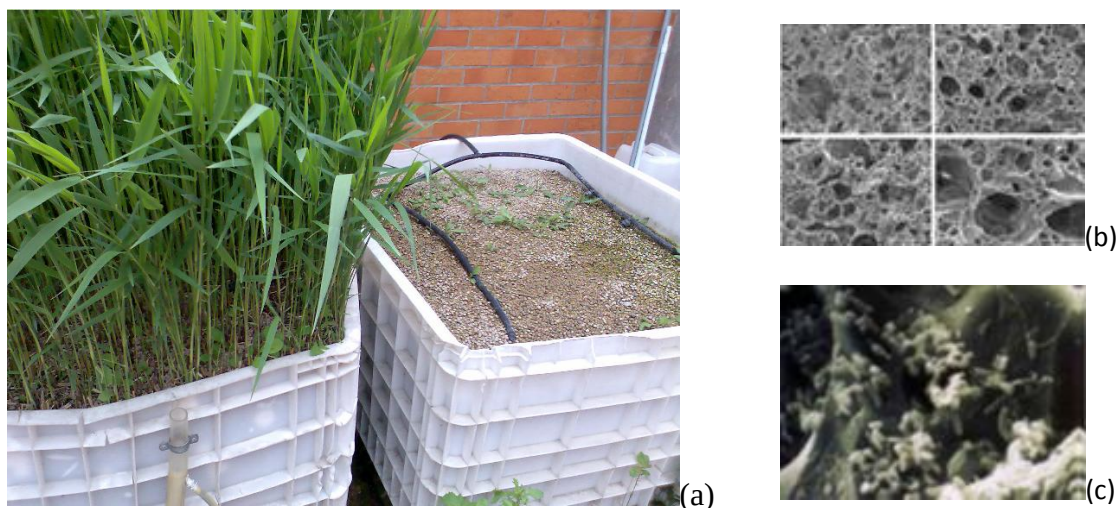
Figura 2.4 - (a) Instalação piloto de uma zona húmida existente no departamento de Engenharia Química, desde 2005, no Instituto Politécnico de Tomar em que o enchimento dos tanques é a argila expandida; (b) Análise microscópica da argila expandida; (c) Superfície da argila expandida com bactérias produzindo uma área de biofilme.
