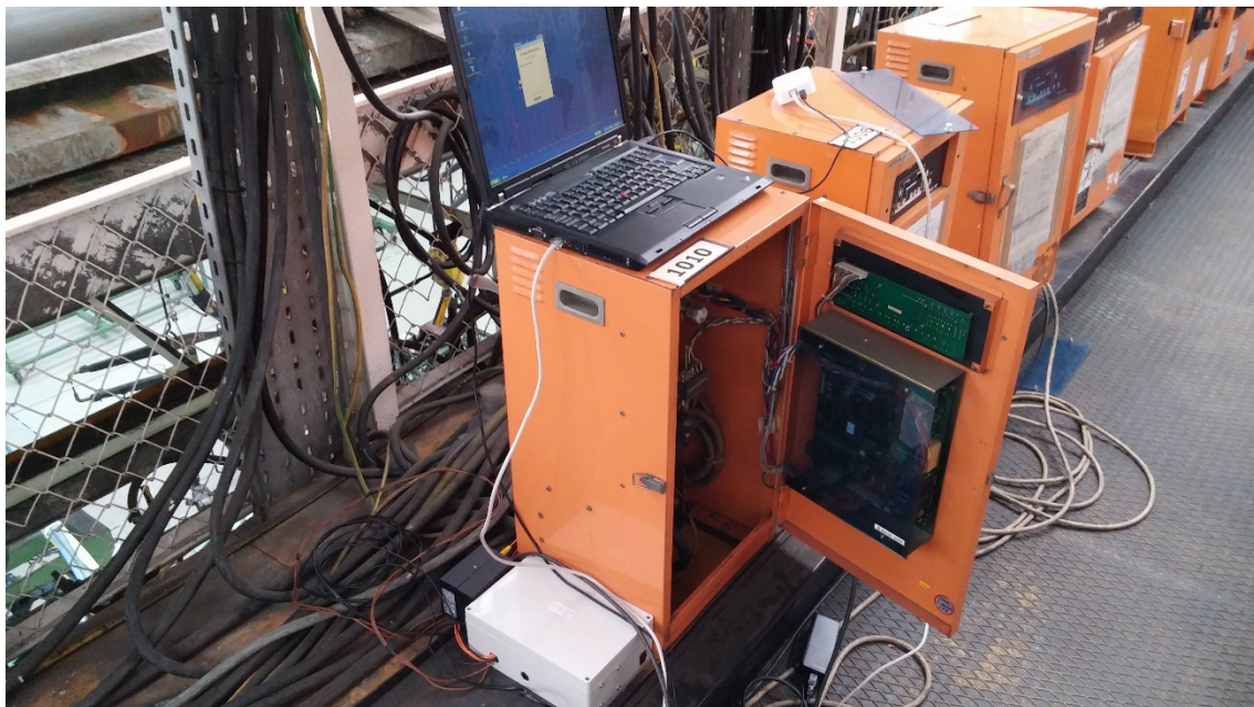
Figura 17 - Módulo “MASTER” em comunicação com um PC.
