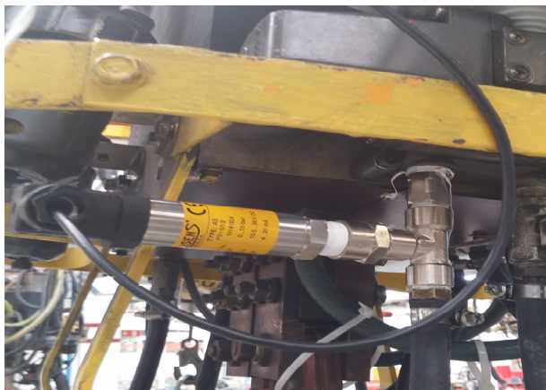
Figura 37 - Sensor de pressão instalado na máquina de soldadura.
