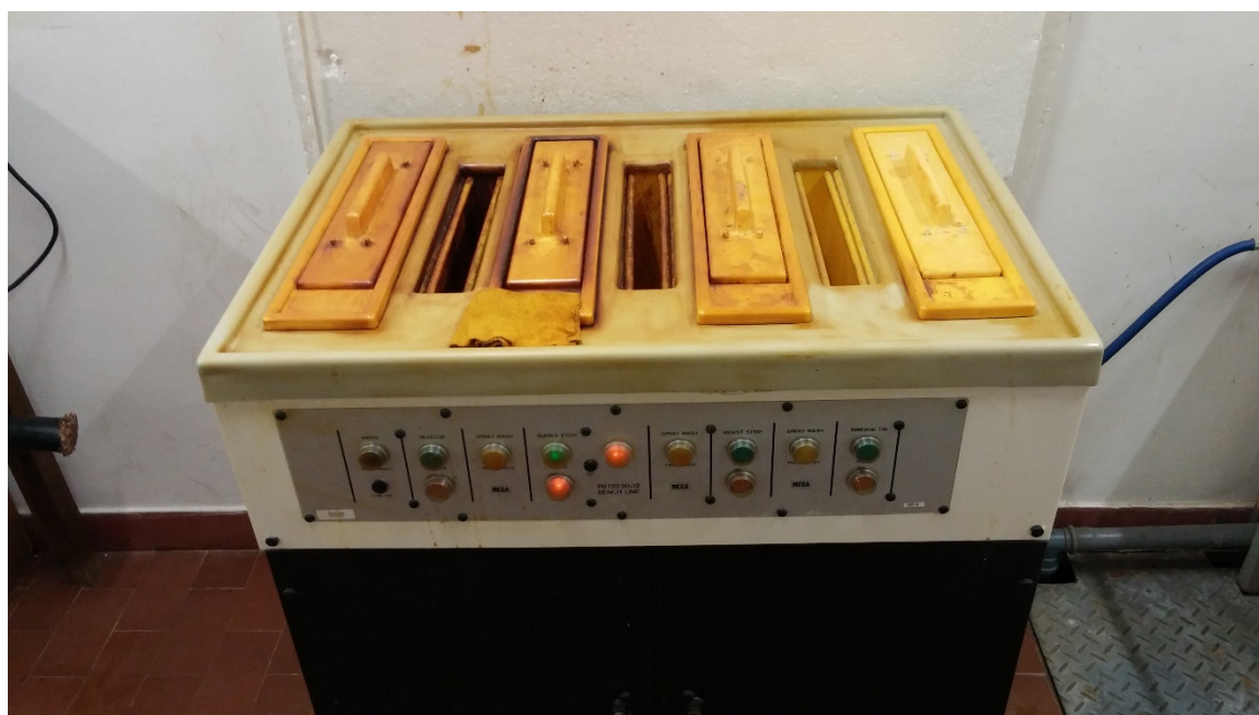
Figura 120 - Tanque de Percloroeto de ferro.
