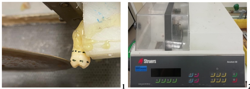
Figura 6 - 1- Dente fixo à base acrílica com cera colante; 2- Micrótomo de tecidos duros (Accutom-50, Struers A/S, Ballerup, Denmark)
