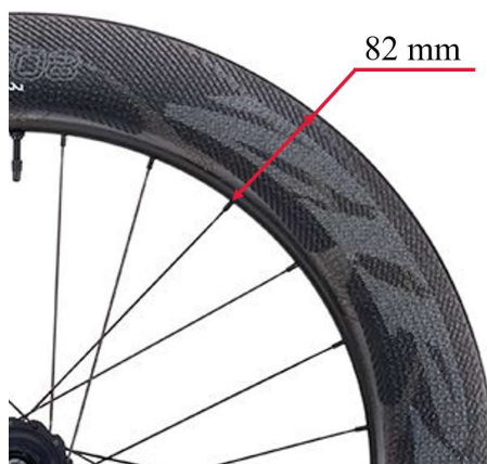
Figura 3.1.7 – Profundidade do aro do modelo 808 NSW (ZIPP, 2017)
