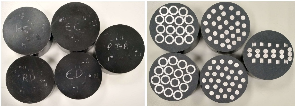
Figura 3.4.5 – Moldes-teste para verificação do tempo de vida do disco de granulometria #80
