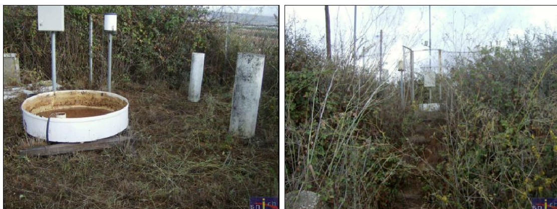
Figura 71 - Estação meteorológica automática com telemetria de São Julião do Tojal - 20C/01C [65]
