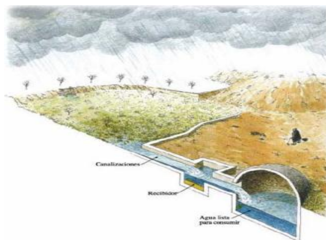
Figura 8 - Aljibes ou cisternas de armazenamento de água pluvial na Andaluzia, em Espanha [16]
