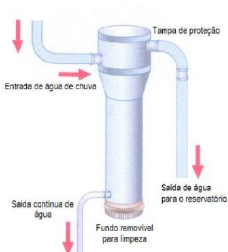
Figura 44 - Dispositivo de primeira lavagem [48]
