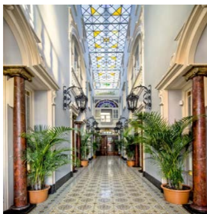
Fotografia 204 - Palacete Chafariz D'El Rei - Corredor com pavimento em mosaico hidráulico e tecto com vitrais.
