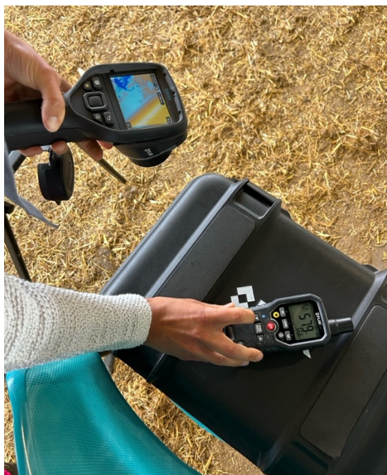
FIGURA 9- CÂMARA TERMOGRÁFICA FLIR E60BX E TERMOHIGRÓMETRO FLIR MR77 UTILIZADOS NA RECOLHA DAS IMAGENS TERMOGRÁFICAS E MONITORIZAÇÃO DAS CONDIÇÕES AMBIENTAIS
