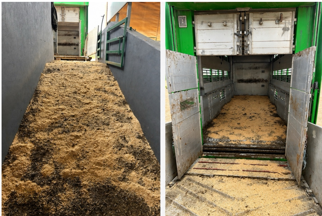
FIGURA 3- PREPARAÇÃO DAS SUPERFÍCIES DE DESLOCAÇÃO DOS ANIMAIS DURANTE O ENSAIO. À ESQUERDA, CORREDOR DE ACESSO AO VEÍCULO DE TRANSPORTE. À DIREITA, INTERIOR DO VEÍCULO UTILIZADO PARA A SIMULAÇÃO DO TRANSPORTE, IGUALMENTE PREPARADO COM SERRADURA PARA MELHORAR A ADERÊNCIA E REDUZIR O RISCO DE ESCORREGAMENTO, A APLICAR NO GRUPO EXPERIMENTAL.
