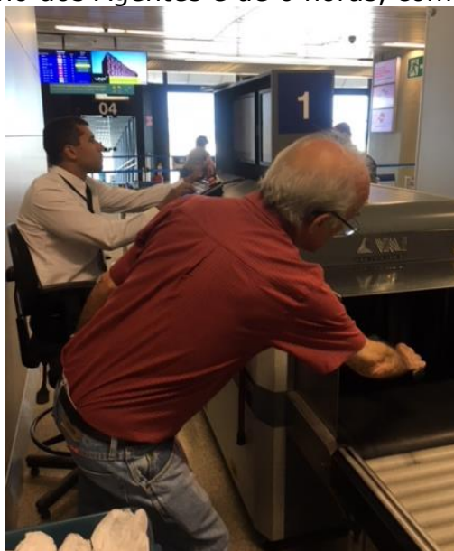
Figura 4 – Medição na saída, junto à cortina plumbífera
