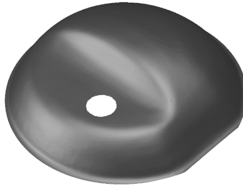
Figura 45 – Modelo CAD da cobertura de diferencial da viatura HMMWV obtido através do scanner 3D e com alterações aplicadas.
