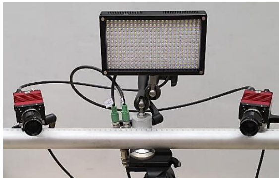
Figura 26 – Sistema de Correlação Digital de Imagens Dantec Dynamics Q-400 3D.
