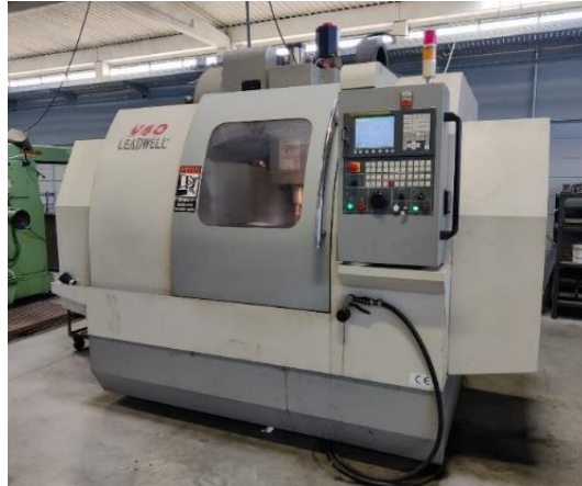
Figura 30 – Centro de maquinagem Leadwell V40.
