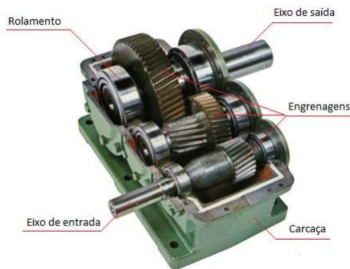
Figura 43 - Constituição de um redutor [55]
