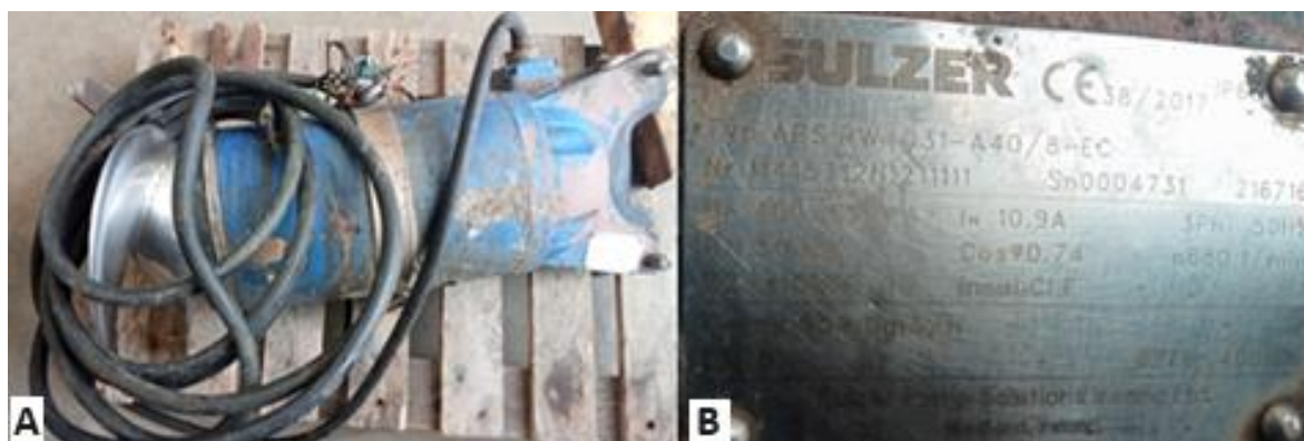
Figura 80 - (A) Agitador submersível; (B) Chapa de características
