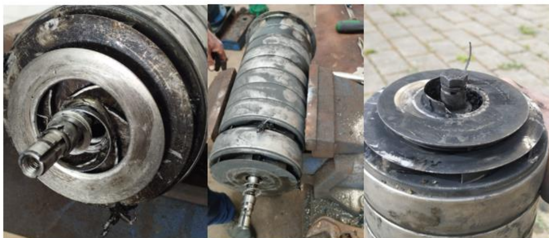
Figura 79 - Conjunto hidráulico danificado
