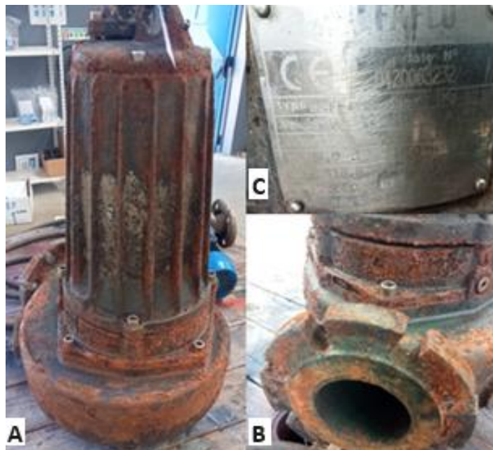
Figura 76 - (A) Corpo da bomba; (B)Voluta; (C) Chapa de características
