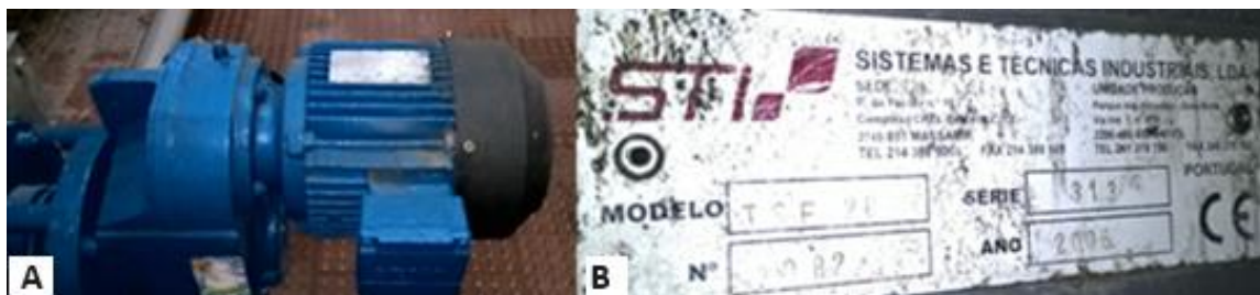
Figura 84 - (A) Motorreductor; (B) Chapa de características
