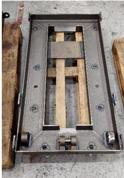
Figura 6.7 — Base Inferior Totalmente Soldada.
