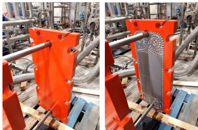
Figura 5.8 – Novo Desenho Estrutura DN 65: a) Placa Móvel; b) Placa Móvel com PTC.
