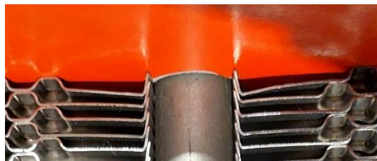
Figura 5.7 — Deformação nos Alinhadores.
