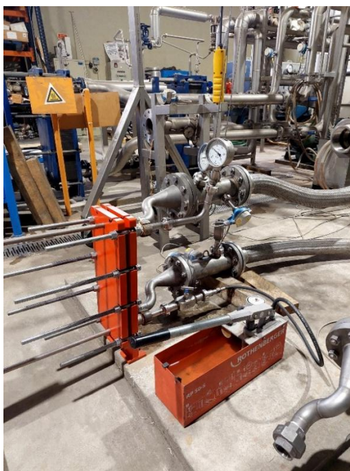
Figura 5.15 — Testes Hidrodinâmicos Skills DN 32.
